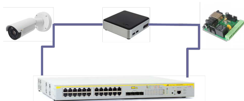
Fig. 3.3. Arhitectura sistemului LPR
